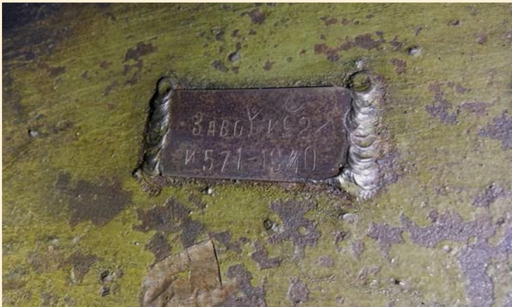
Tabliczka znamionowa pancerza NPS-3 produkcji Zasod №92 z oznaczonym rokiem produkcji. Zwraca uwagę zachowana oryginalna oliwkowa farba, którą fabrycznie pokrywano pancerze NPS-3. Fot. K. Jankus
