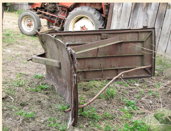
Plug do odśnieżania, wykonany z pary drzwi technicznych stosowanych we wnętrzach schronów bojowych. Fot. M.Kozdrój
