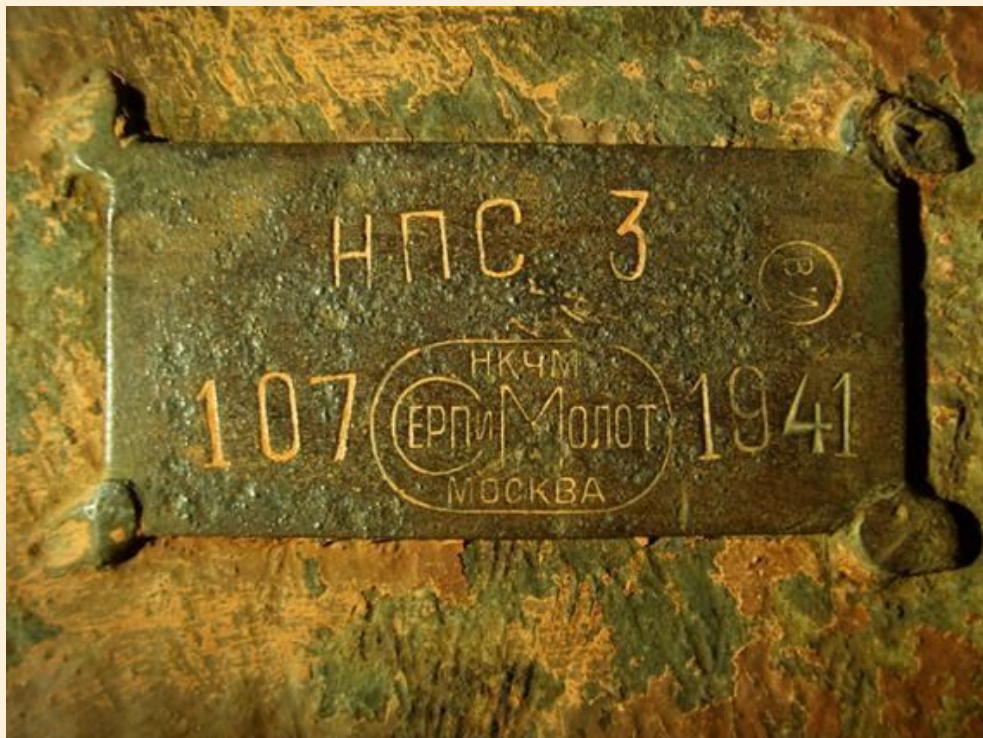
„Sierp i Młot” - pełnowymiarowa tabliczka znamionowa pancerza NPS-3 mocowana po prawej stronie wewnętrznej części pancerza skrzyniowego. Fot. M. Kozdrój
