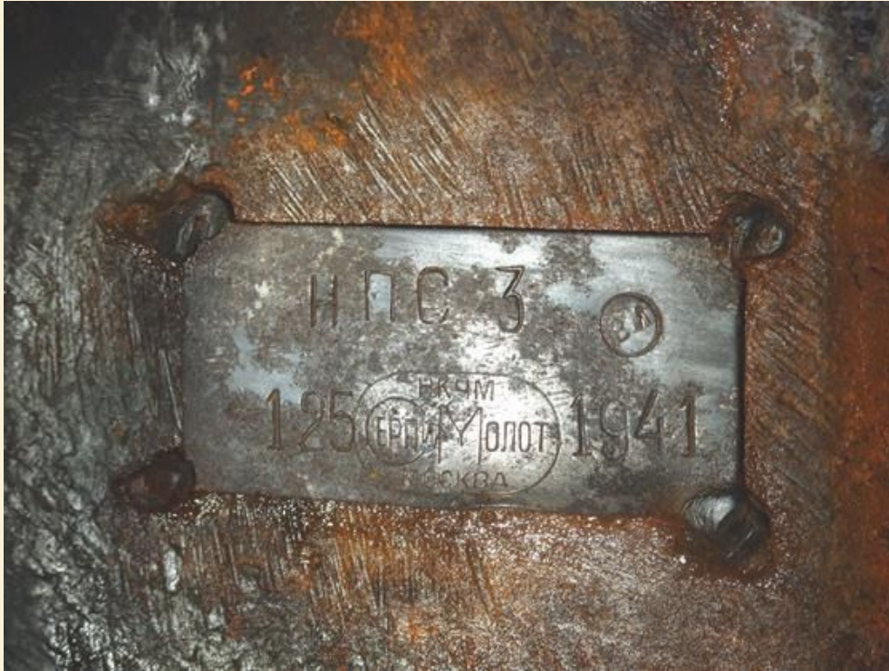
“Sierp i Młot” - inny egzemplarz pełnowymiarowej tabliczki znamionowej panczerza NPS-3 mocowany po prawej stronie wewnętrznej części panczerza skrzyniowego. Fot. M. Świtalski
