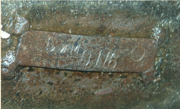
„Sierp i Młot”- uproszczona (zastępcza) tabliczka znamionowa pancerza NPS-3.
