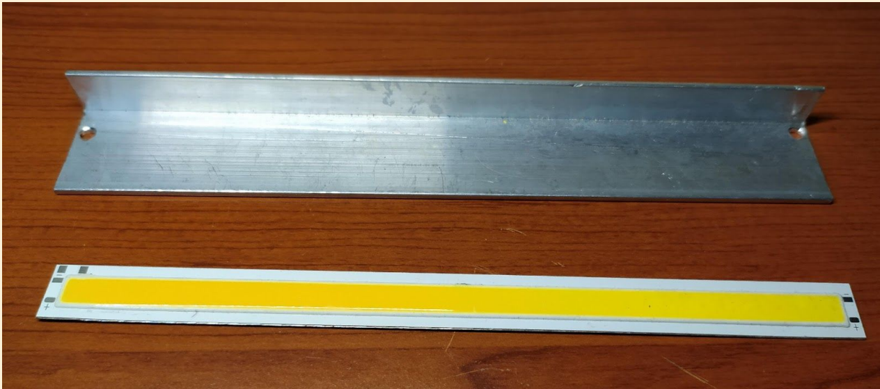
Aluminiowy kątownik oraz listwa LED. Fot. D. Nurzyński
