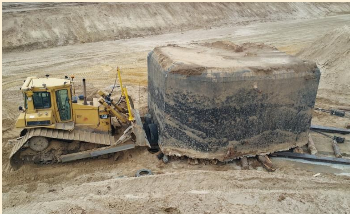
Spycharka gąsienicowa CAT – odtylna siła wspomagająca. Fot. P. Tymiński
