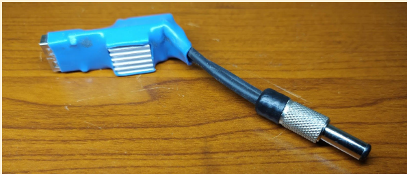
Wyjście zasilania dla urządzeń ze złączem USB (elektroniczna przetwornica zakupiona przez internet wzbogacona o radiator i dodatkowy kondensator ze złączem umożliwiającym podłączenie). Fot. D.Nurzyński
