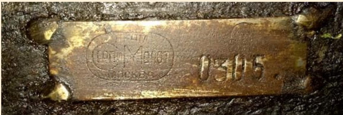
Fot. 9. "Sierp i Młot" - standardowa tabliczka znamionowa pancerza NPS-3: po lewej logo zakładu, po prawej numer seryjny pancerza. Fot. M. Kozak.
