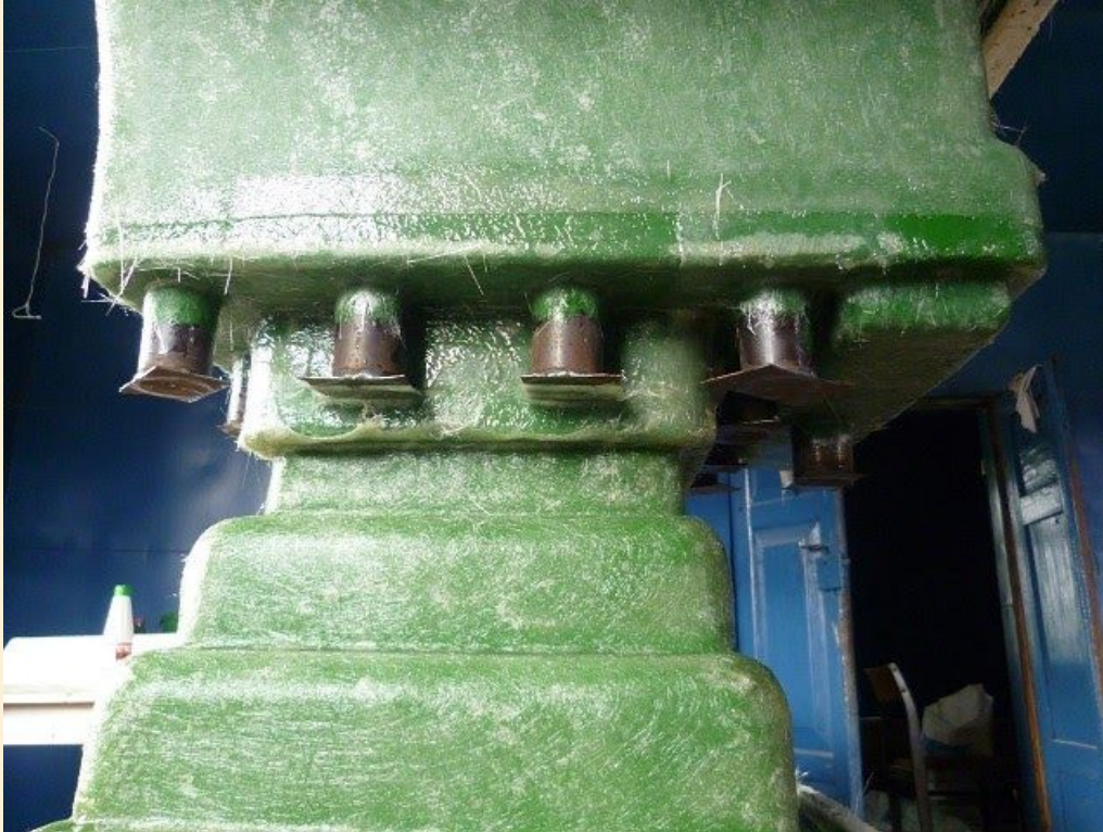
Forma pokryta żywicą poliestrową – widoczne gniazda śrub mocujących płytę dociskową jarzma. Fot. J. Kułak
