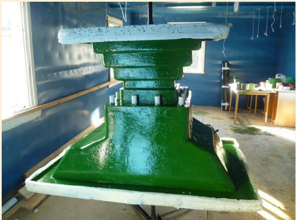
Podkład wykonany żelkotem. Fot. J. Kulak
