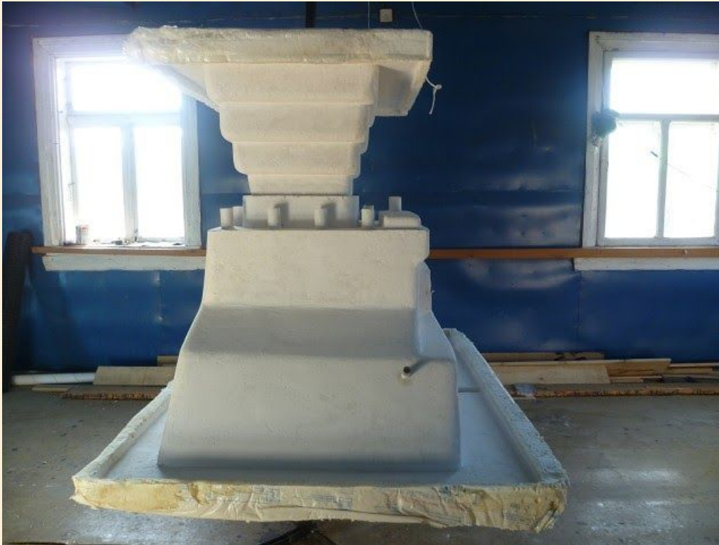
Powierzchnia formy wyrównana gipsem szpachlowym. Fot. J. Kulak
