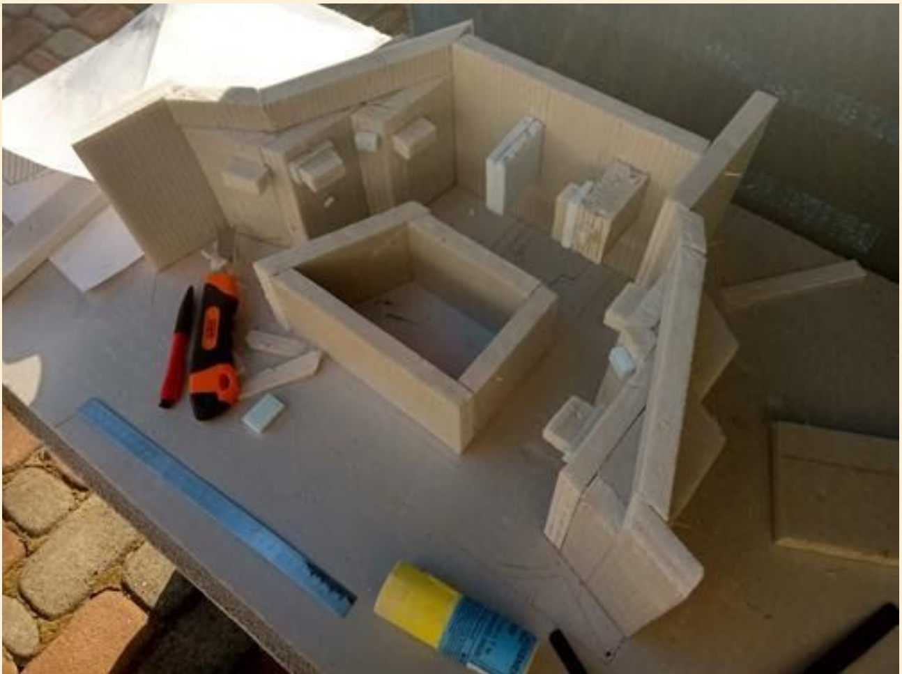
Przygotowanie szalunków z zarysem kaponiery. Fot. O. Kreszczanow
