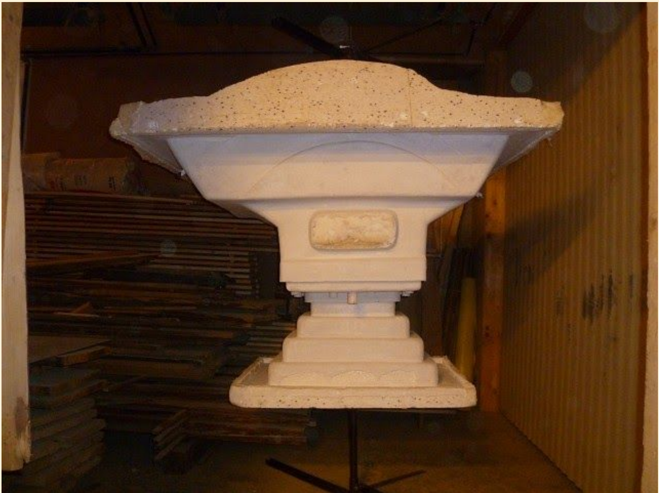
Wykonana forma w stanie surowym. Fot. J. Kulak
